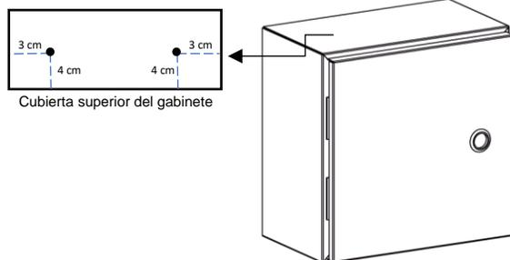
2. Realice 2 perforaciones sobre las marcas hechas en la cubierta superior del gabinete con un taladro y broca 5/16 para acero al carbón
